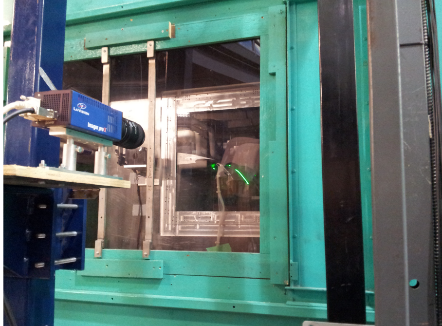
Figure 5.16: PIV camera ImaXer ProX 4M
